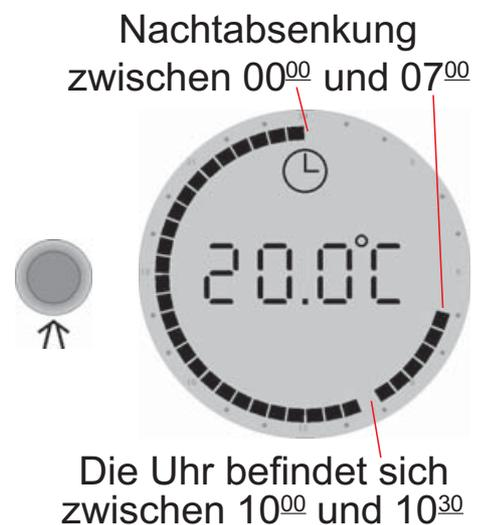
*Die Markierung am Uhrenring zeigt an, wann die normale Temperatur und wann die Absenkttemperatur eingeschaltet ist. Der blinkende Punkt zeigt die aktuelle Uhrzeit an (alle halbe Stunde).*
