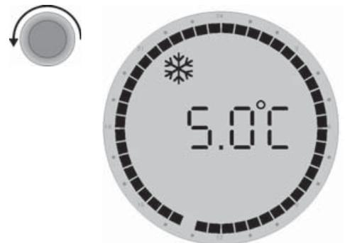
Reduzieren Sie die Temperatur weiter, schaltet der **deviheat**<sup>®</sup> 550 komplett aus (Nur im Manualbetrieb möglich). Erhöhen Sie die Temperatur wieder, schaltet der **deviheat**<sup>®</sup> 550 automatisch wieder ein.
